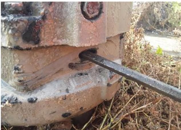
← **La pompe défectueuse et la lame introduite permet d'identifier le trou. C'est vraisemblablement un gros caillou qui est resté coincé et a provoqué le percement de la paroi de la pompe.**
